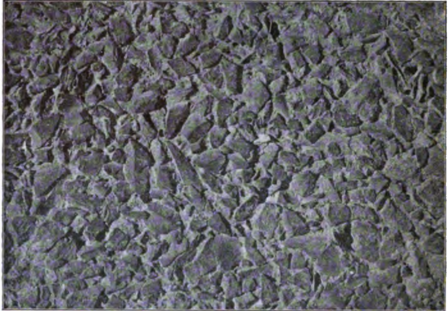
Abb. 129. Vorsetzbeton, gewaschen und abgebläutet. 1 Teil Zement, 2 Teile gelber Grobsand, 3 Teile durchgeworfener Steingrus von 1 cm Korngröße.
